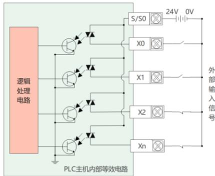
● 输入源型接线 (PNP型传感器)
