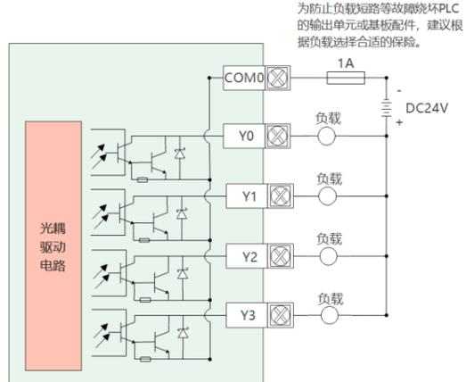
为防止负载短路等故障损坏PLC的输出单元或基板配件, 建议根据负载选择合适的保险。
